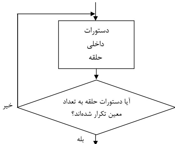
همانطور که می‌بینید، با هر بار اجرای دستورات حلقه، میکروکنترلر بررسی می‌کند آیا حلقه به تعداد معین تکرار شده یا خیر و در صورت لزوم دستورات را تکرار می‌کند.
