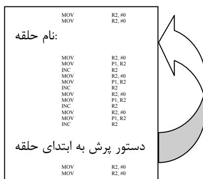
حلقه‌ها از دیدگاه تعداد تکرار دستورات به دو دسته تقسیم می‌شوند: حلقه‌های تکرار نامعین، حلقه‌هایی هستند که تعداد تکرار دستورات داخلی آنها مشخص نیست؛ شکل.... را بینید.
