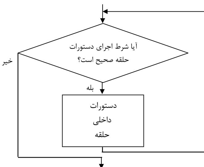
هربار در ابتدای حلقه، شرطی کنترل می‌شود و در صورت صحت آن، دستورات داخل حلقه تکرار می‌شوند. حالت خاصی از حلقه‌های تکرار نامعین به حلقه‌های تکرار بینهایت<sup>۱</sup> معروفند که دستورات داخل آنها بینهایت بار (تا قبل از خاموش شدن میکروکنترلر) اجرا می‌شوند.
