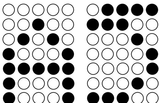
روش نمایش یک کاراکتر در نمایشگر ماتریس – نقطه ای به این صورت است که برای آن کاراکتر یک الگوی ماتریسی (مانند آنچه در شکل بالا برای حرف A یا «ح» می بینید) در نظر می گیریم. برای نمایش یک کاراکتر روی نمایشگر ماتریس – نقطه ای، می توان هر LED نمایشگر را به یک پین میکروکنترلر متصل کرد. اما این روش پنهانهای زیادی از میکروکنترلر را اشغال می کند. به همین دلیل، معمولاً نمایشگرهای ماتریس – نقطه ای را به صورت ماتریسی (شکل....) می سازند.
