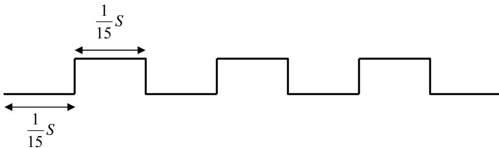
این نشان می‌دهد که اگر فرکانس خاموش و روشن شدن یک LED کمتر از  $7/5$  هرتز باشد، چشمک زدن آن به راحتی دیده می‌شود. بنابراین اگر در مثال ... یک LED به پین P1.0 متصل شود، چشمک زدن آن دیده می‌شود.
