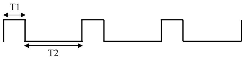
در مثال ... چون زمان روشن و خاموش بودن موج مربعی یکسان است، سیکل وظیفه آن  $50\%$  است. دانستیم اگر موج مربعی با فرکانس  $7/5$  هرتز و زمان روشن و خاموش بودن یکسان (سیکل وظیفه  $50\%$ ) به یک LED اعمال شود، خاموش و روشن شدن LED دیده می‌شود.
