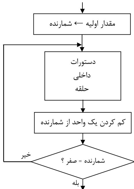
شمارنده<sup>۱</sup> یکی از ثباتهای میکروکنترلر است که عمل شمارش تعداد دستورات حلقه را بر عهده دارد و قبل از ورود به حلقه مقداردهی می‌شود. با هر بار اجرای حلقه یک واحد از شمارنده کم می‌شود و اگر مقدار آن صفر نشده بود، دوباره دستورات حلقه اجرا می‌شوند. با مثالی نحوه پیاده‌سازی حلقه‌های تکرار معین را بررسی می‌کنیم.
