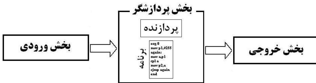
شکل ۱-۵ - یک سیستم کنترلی مبتنی بر پردازنده
