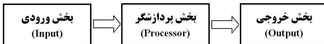
شکل ۱-۱- اجزاء یک سیستم کنترلی
